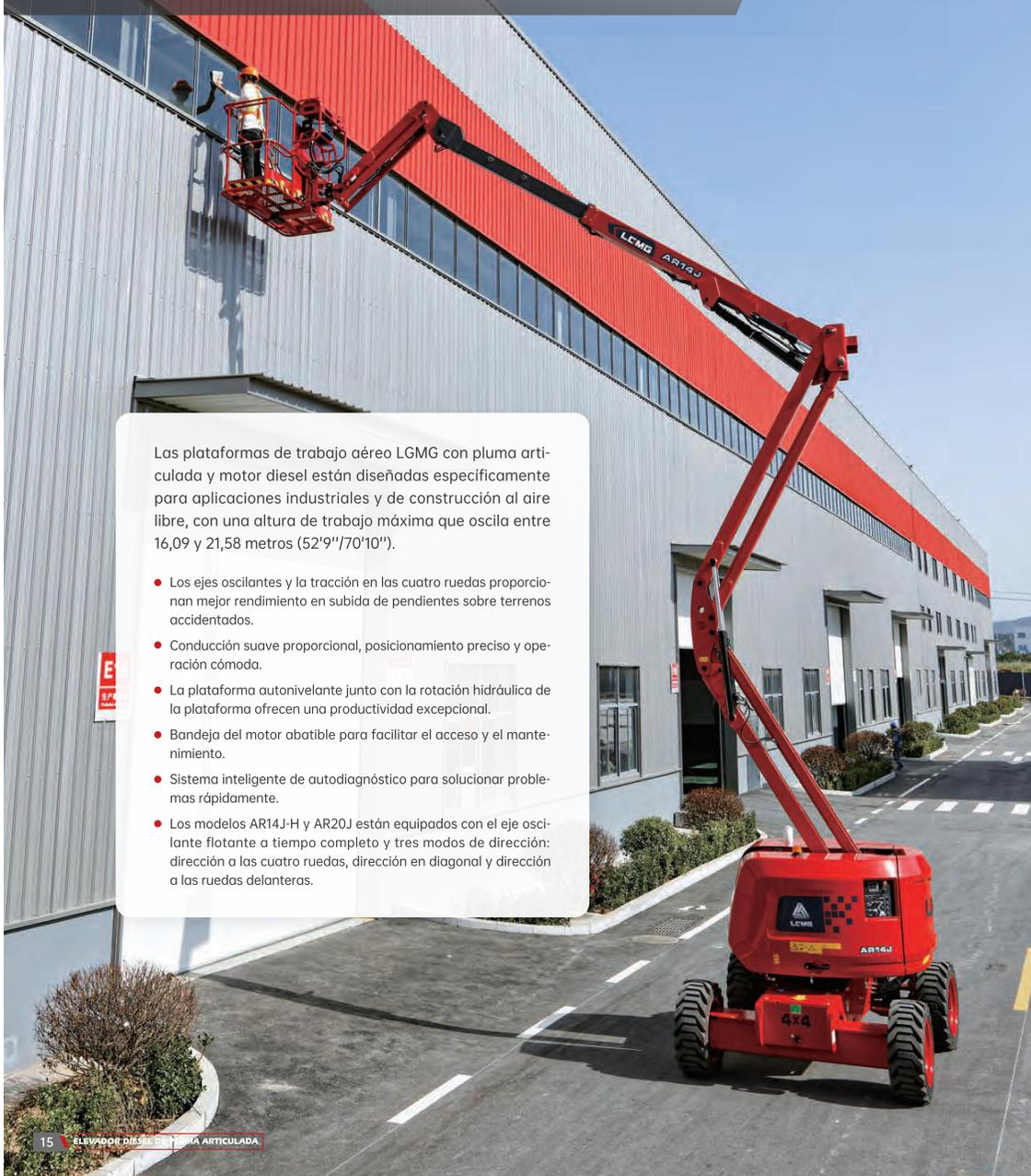
Las plataformas de trabajo aéreo LGMG con pluma articulada y motor diesel están diseñadas específicamente para aplicaciones industriales y de construcción al aire libre, con una altura de trabajo máxima que oscila entre 16,09 y 21,58 metros (52'9"/70'10").
