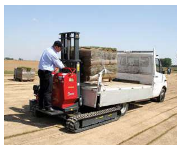
El espacio entre orugas se adapta a cada tipo de traslación: menor tamaño donde es necesario y mayor estabilidad en caso de terreno irregular.
