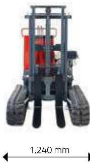
Lo spazio tra i cingoli è adatto ad ogni tipo di trasporto, minore ingombro dove serve e maggiore stabilità in caso di terreno sconnesso.
