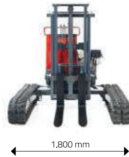
El espacio entre orugas se adapta a cada tipo de traslación: menor tamaño donde es necesario y mayor estabilidad en caso de terreno irregular.
