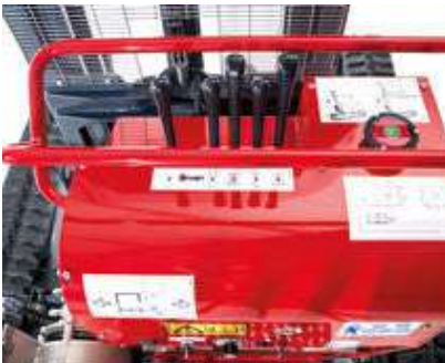
In configurazione di trasporto è possibile selezionare la doppia velocità. En posición de transporte es posible seleccionar la doble velocidad
