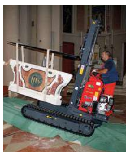
Lo spazio tra i cingoli è adatto ad ogni tipo di trasporto, minore ingombro dove serve e maggiore stabilità in caso di terreno sconnesso.
